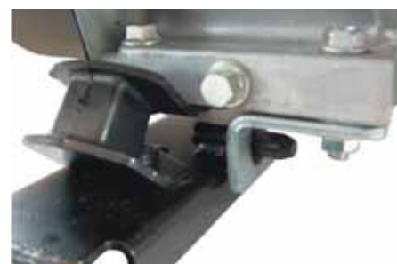
▲ Ustawione pod kątem 45° v-amortyzatory
